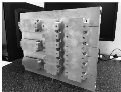
图 8 冷板和热电阻模拟功率模块
