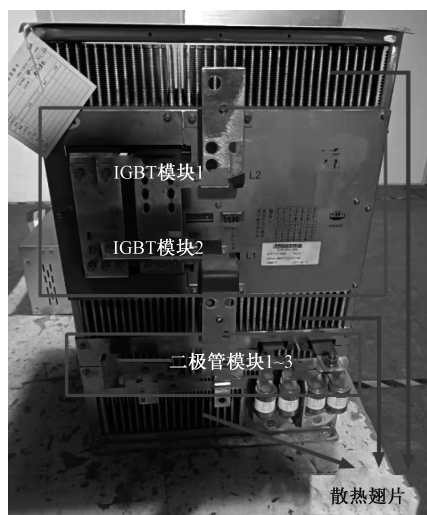
图3 空冷方案变频器功率单元
