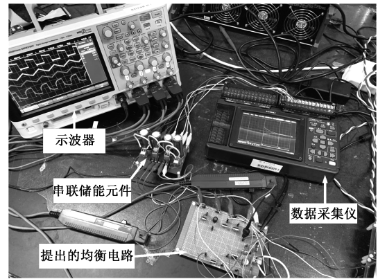
图10 均衡电路样机和实验平台
