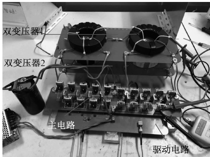
图 7 基于多变压器的双极性 Marx 电路的测试
