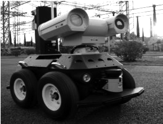
图 5 变电站巡检机器人实物图 Fig.5 Substation inspection robot
