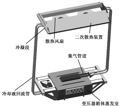
图6 车载牵引变压器自循环系统
