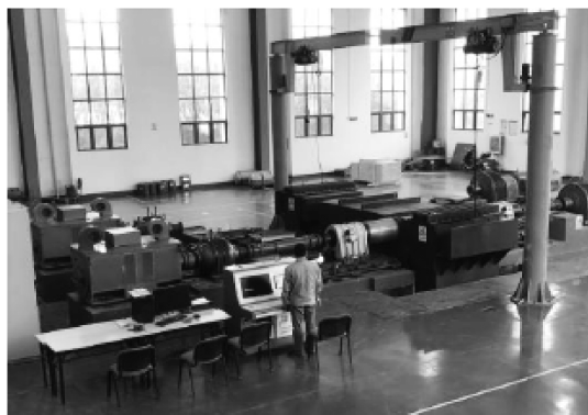
图13 1 MW 超导感应加热装置
