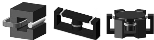
图 6 多磁路新型感应加热结构
