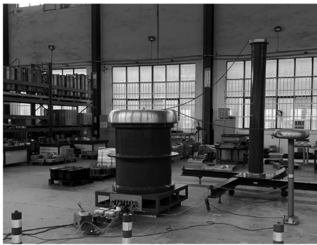
图19 200 kV, 100 kV·A 磁控谐振变压器试验现场
