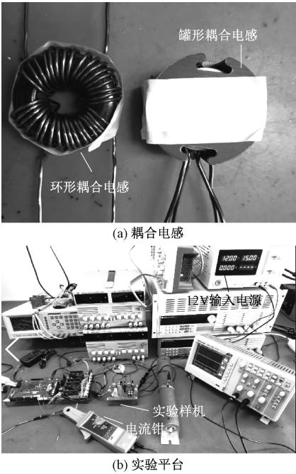
图 12 耦合电感与样机实验平台
