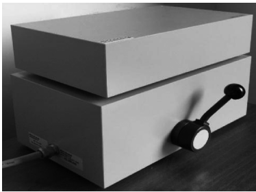
图 1 磁化特性单片测量装置
