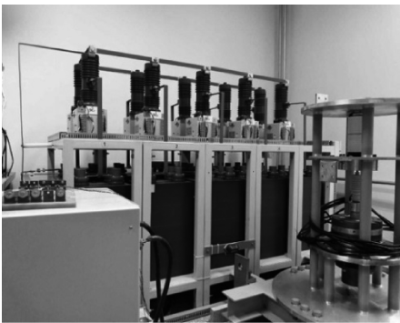
图 6 高压直流短路冲击平台 Fig. 6 High voltage DC short circuit impulse platform
