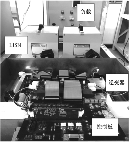
图 1 EMI 测试装置 Fig. 1 EMI test setup
