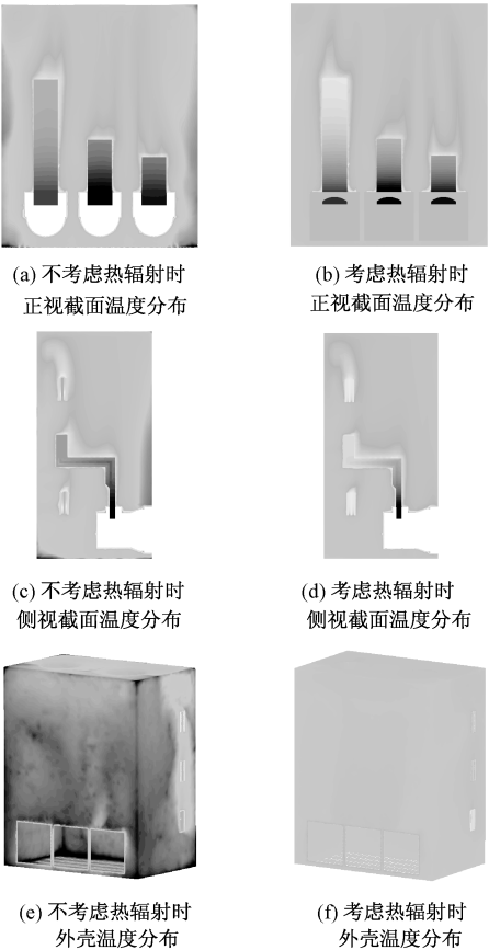
图9 考虑热辐射前后温度分布对比 Fig. 9 Comparison of temperature distribution
