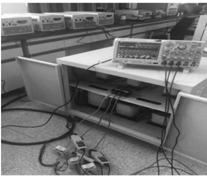
图 13 弱电网下光伏并网逆变器系统硬件实验平台
