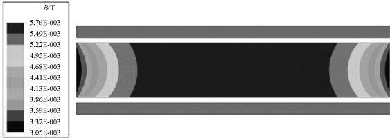
图4 螺线管磁通密度云图
