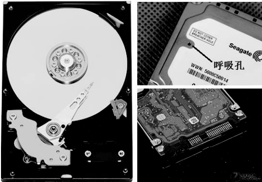
图1 传统机械硬盘结构
