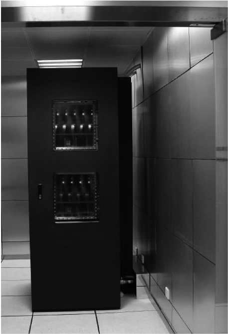
图7 TC3600 喷淋式蒸发冷却超级计算机
