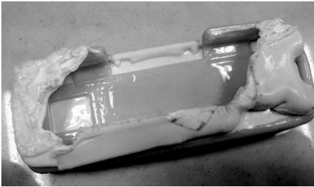
图 5 U 盘塑料外壳与介质发生明显反应
