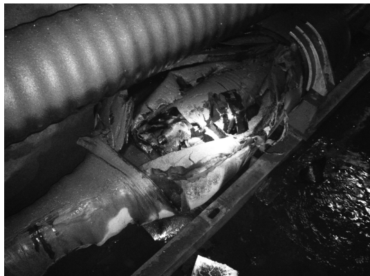
图 1 现场电缆接头故障
